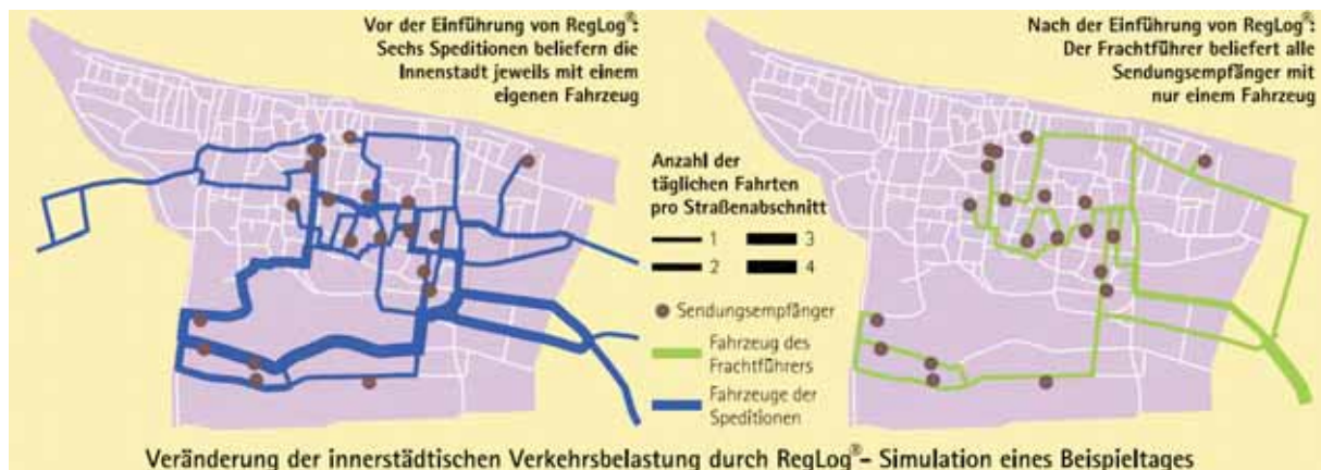
Abbildung 2: Veränderung der innerstädtischen Verkehrsbelastung durch RegLog® - Simulation eines Beispieltages (Stadtatlas Regensburg 2006, S. 117)
